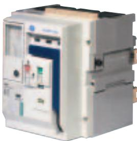
Interruptor de corte em carga com comando manual, Interruptor (sem relé de protecção disponível) e 8 contactos auxiliares (5NA e 3NF) e pinças de extracção.
