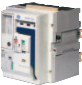
Interruptor de corte em carga com comando manual, interruptor (sem relé de protecção disponível) e 8 contactos auxiliares (5NA e 3NF) e pinças para extracção.
