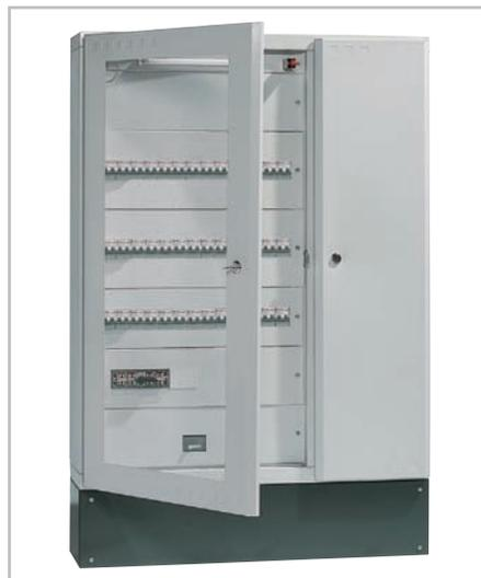
Nos armários de 900mm de largura, a cela lateral para os cabos ou barramento está incluída. Toda a aparelhagem é instalada sobre o painel posterior. O posicionamento da cela lateral pode ser à direita ou à esquerda, sendo escolhido no momento da montagem do quadro. As portas e os espelhos fabricados com 1mm de espessura e protegidas por uma camada de tinta epóxy de cor RAL 7035 garantem um acabamento estético e de qualidade.
