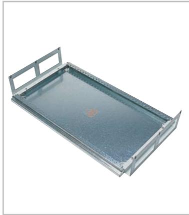
O painel posterior, fabricado em chapa metálica galvanizada com 1,5mm de espessura, contém furos de Ø 8 mm, de 25 em 25mm. De acordo com a norma CEM, a chapa metálica galvanizada assegura uma melhor continuidade das massas.
