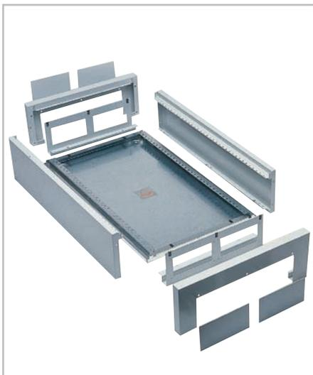
Fabricados em chapa com aço, protegida com uma camada de tinta epóxy de cor RAL 7035. Os armários estão disponíveis em duas larguras (600 e 900mm) e em seis alturas (desde 545 até 1295mm) com filas de 150 mm de altura. Fornecidos em forma de kit, de montagem e instalação simples.
