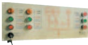
Fornecido para um transformador, com outro de emergência e um gerador ou transformador de emergência. Apenas pode fechar o interruptor/disjuntor cuja tensão esteja disponível, sendo a da Rede preferida. Para que feche um interruptor/disjuntor é necessário que os outros dois estejam abertos.
